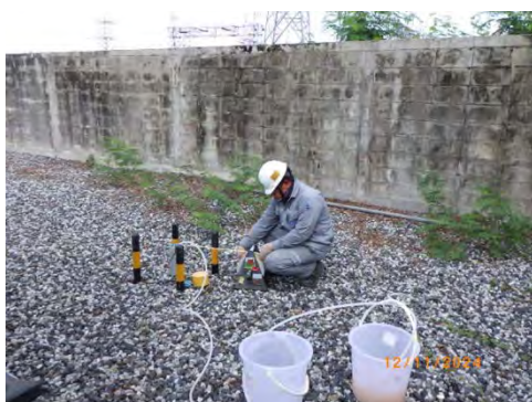
ภาพที่ 2-11 ป่อสังเกตการณ์ (Monitoring Well)
